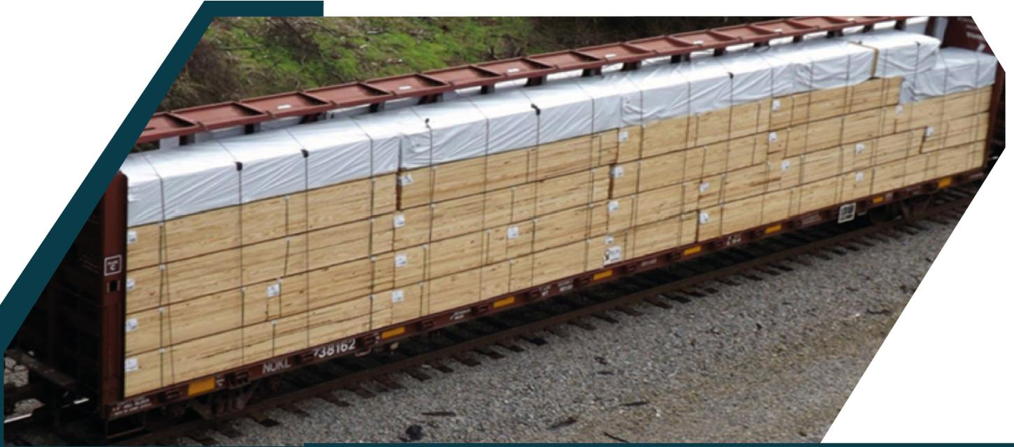
otros usos para la plataforma como envíos de tuberías, tubos de acero y vigas. La mayoría de las planas tienen una capacidad de 73 pies y 100 toneladas.
