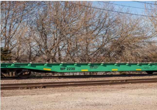
Fig.1. Plataforma sencilla para carga en general de 56 pies, del ferrocarril Western Pacific. Fuente: propia
